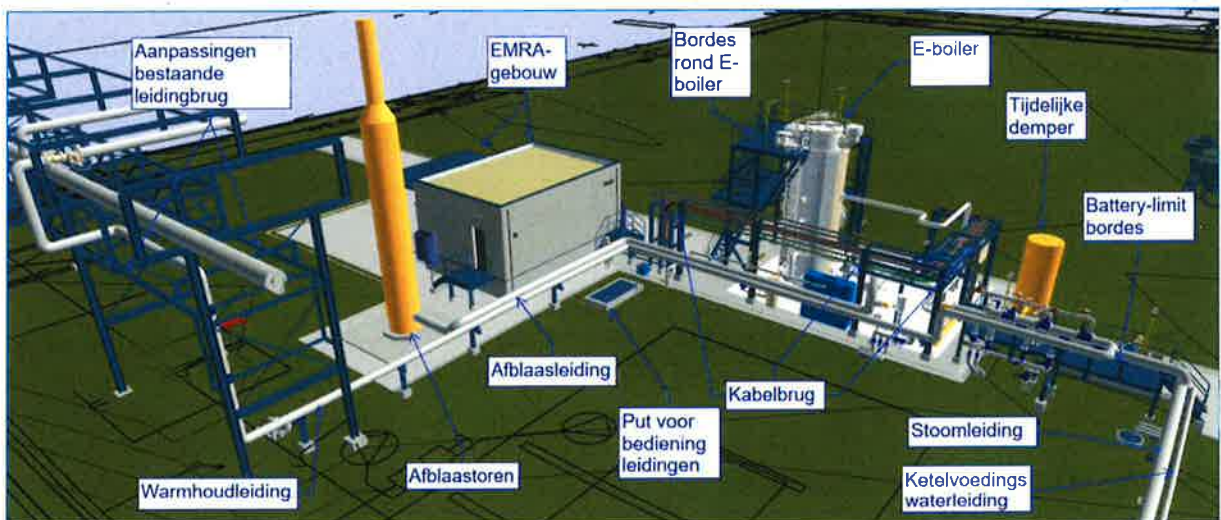
Afbeelding 2 overzicht bouwwerken, (afbeelding afkomstig van het document 'Sterkte- en stabiliteitsberekening met kenmerk: nIT57143 1334101, d.d. 4 juli 2024)
